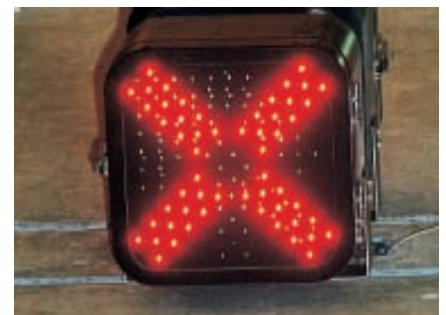
Dauerlichtzeichen in faseroptischer Anzeigetechnik
